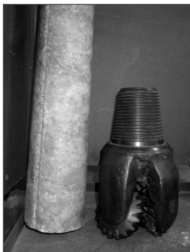
Borekernen er fra boring 4a ved Suldrup. Ved de andre borer udtog man ikke kerneprøver, men borede med det viste roterende mejselbor, som borede hurtigere
